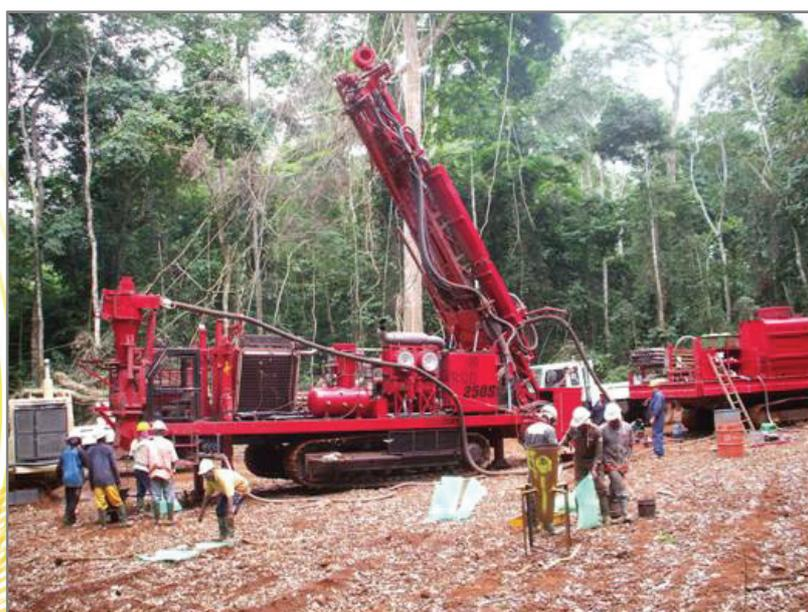
FIGURE 1 – RC DRILLING AT THE MBALAM ITON ORE PROJECT, CAMEROON (MARCH 2008)
