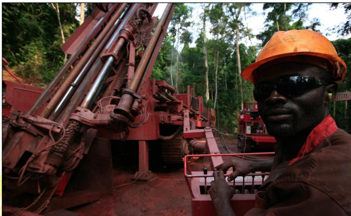
FIGURE 2 - RC DRILLING AT THE MBALAM IRON ORE PROJECT, CAMEROON (JUNE 2008)
